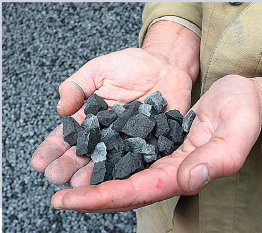
Aufbereiteter Sekundärrohstoff aus Schlacke. © Fraunhofer UMSICHT
