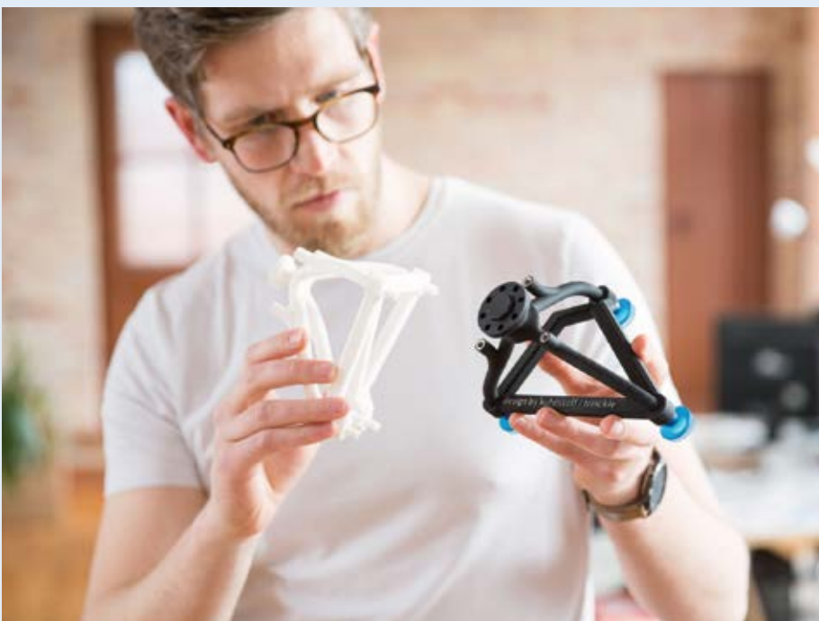
Additiv gefertigte, kundenindividuelle Robotik-Greifer
