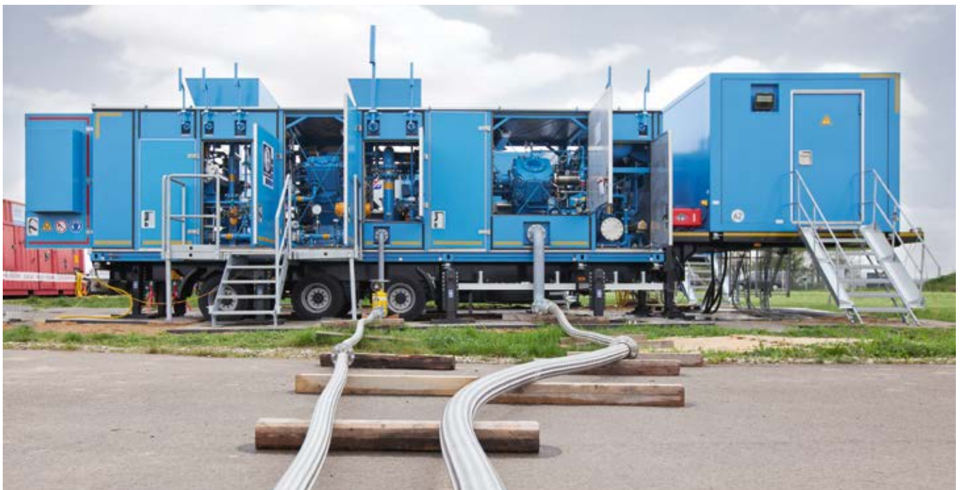
Der mobile Biogasverdichter von ONTRAS ersetzt zeitweise die fest installierte Einspeiseanlage und pumpt vorübergehend Biomethan ins Gasnetz.
