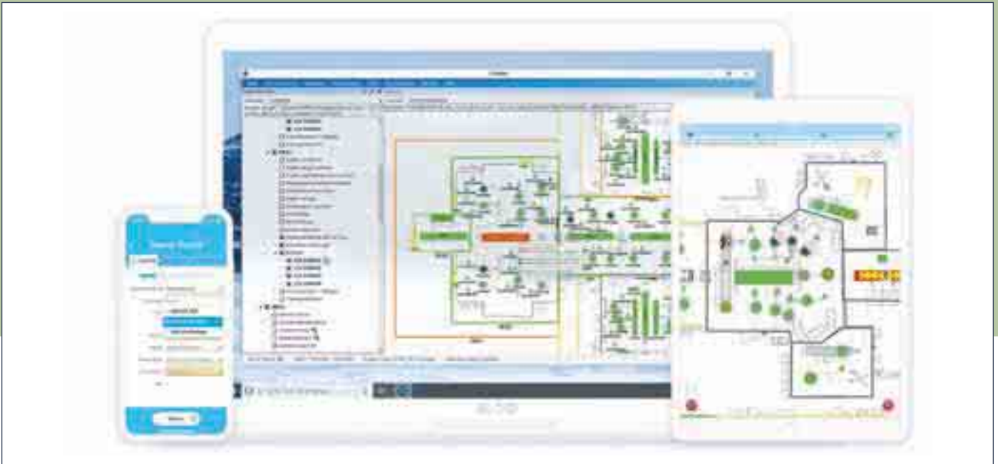
COMAN-Screens: Die Prozessmanagement-Software COMAN visualisiert den Baufortschritt mit Smart Objects und unterstützt ortsbezogene Abläufe.
