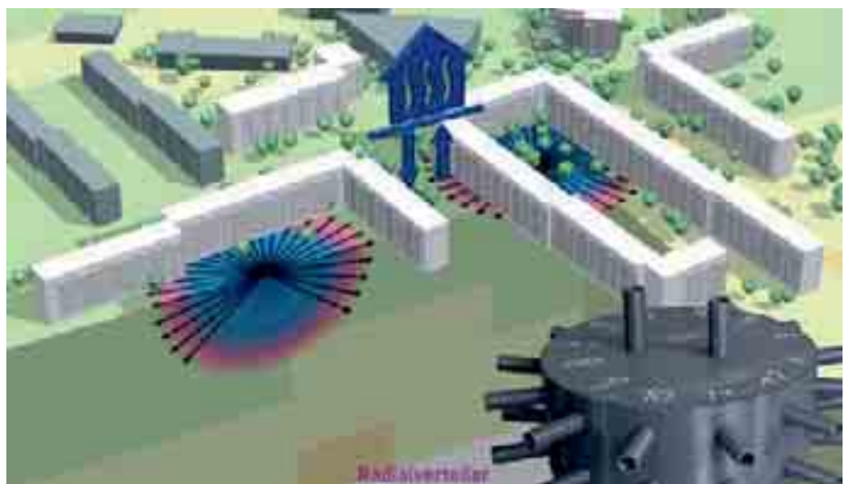
Prinzipskizze GeoHoP und Radialverteiler für Geothermiesonden, Quelle: smood
