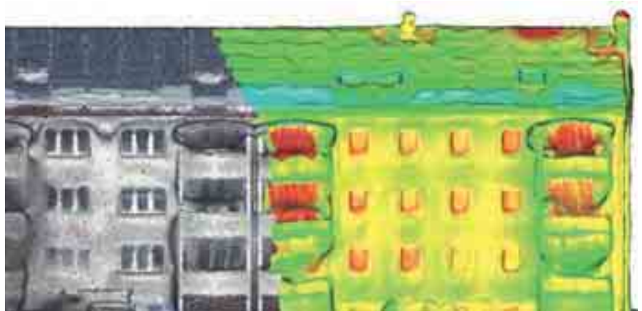
3D-RGB-Rekonstruktion und 3D-Thermographie Modell. Quelle: Bauhaus-Universität Weimar
