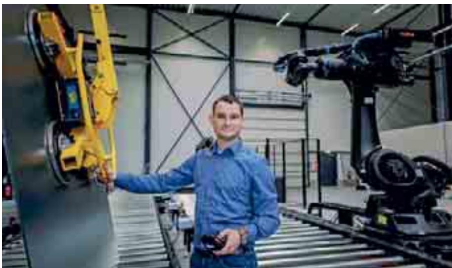
Otto Grauer, der Leiter des Carbonbetontechnikums, demonstriert, wie die Roboter künftig Carbonbetonlege von einem Arbeitsschritt zum nächsten transportieren können. (Bild: Stephan Flad/HTWK Leipzig)
