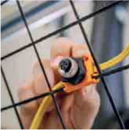
Das gelbe ASi-Kabel verbindet im Carbonbetontechnikum Roboter, Sensoren und Geräte miteinander. Das Kabel transportiert sowohl Strom als auch Daten. (Bild: Stephan Flad/HTWK Leipzig)
