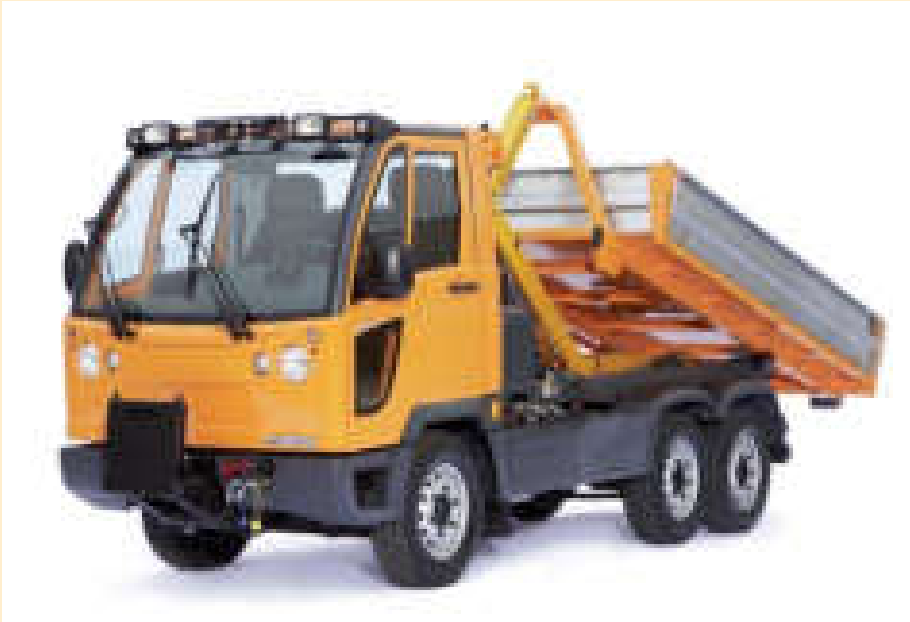
Mit 7,49 Tonnen zulässigem Gesamtgewicht nimmt der Multicar 3-Achser auch schwere Ladung leicht auf. Alle Fotos: Hako GmbH
