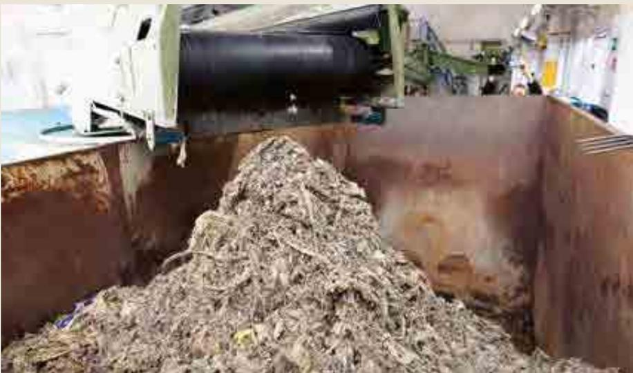
Rechenanlage: Mit dem Abwasser werden ständig grobe Stoffe ins Klärwerk geschwemmt. Von Toilettenpapier über Bockwürste, Kondome und vieles mehr schwimmen ständig im Abwasserstrom. Gelegentlich, so die Erfahrung, finden sich sogar Gebisse und Handys im Rechengut.
