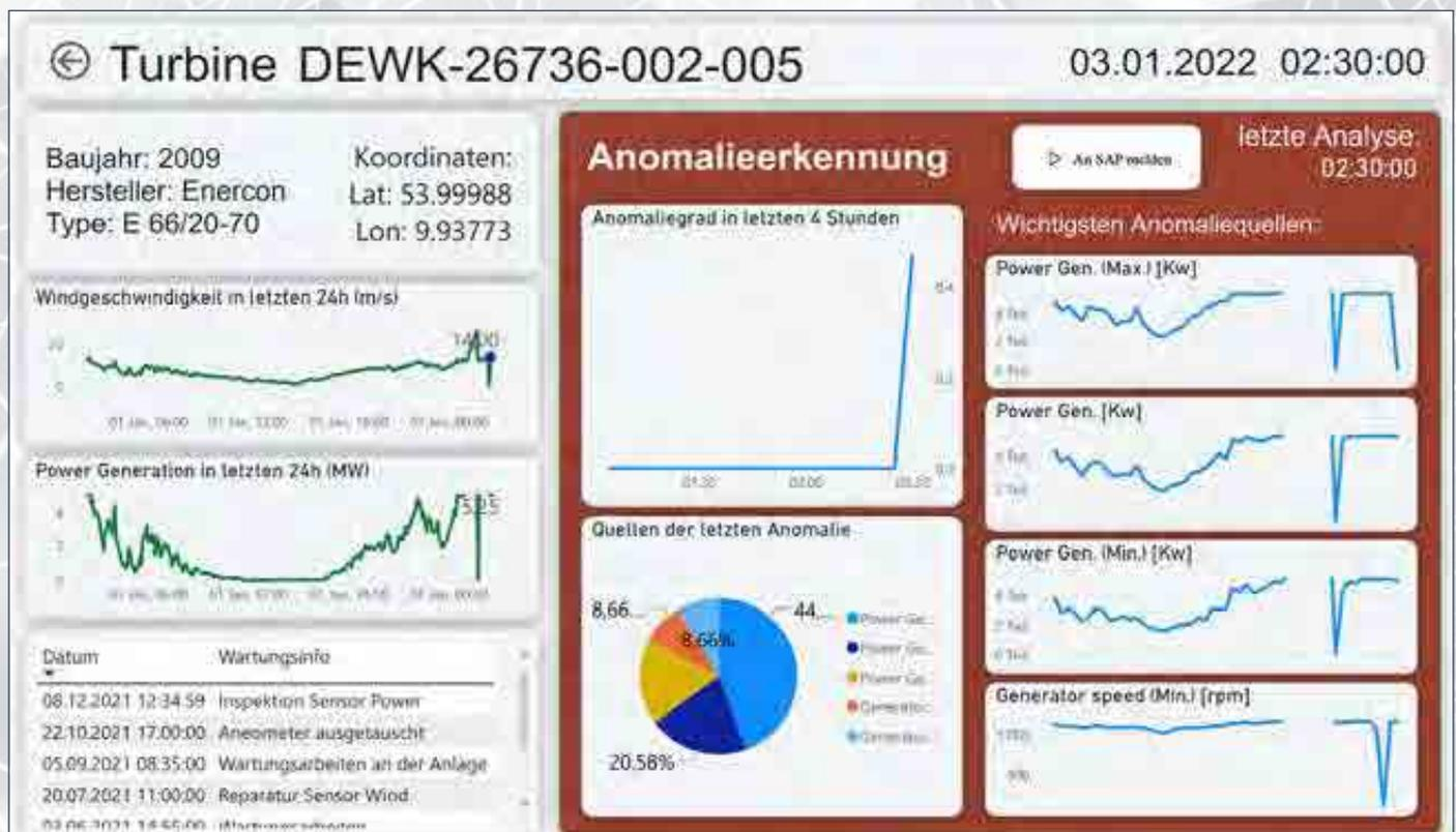
Ein typisches Dashboard [BTC-AG, 2022] zur Anomalie-Erkennung (KI-Service) zur vorausschauenden Wartung bei Windkraftanlagen
