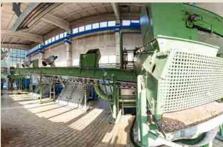
Diese Grobstoffe werden dann automatisch zur Rechengutpresse transportiert. Dort werden sie gewaschen, entwässert und anschließend entsorgt.
