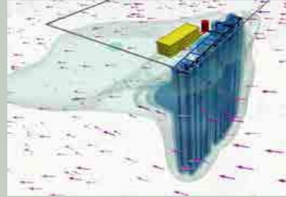
Simulation einer Geothermieanlage einer Berliner Schule. Die Pfeile stellen die Strömung des Grundwassers dar (Grafik: Karsten Rink / UFZ)
